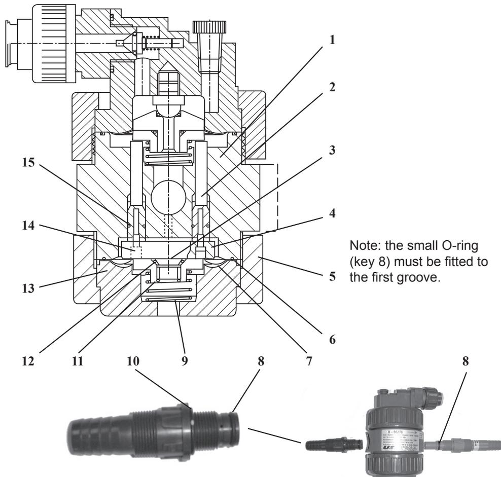
**FIG.9 U.96276 - 19mm ANTI - SYPHON INJECTOR**
