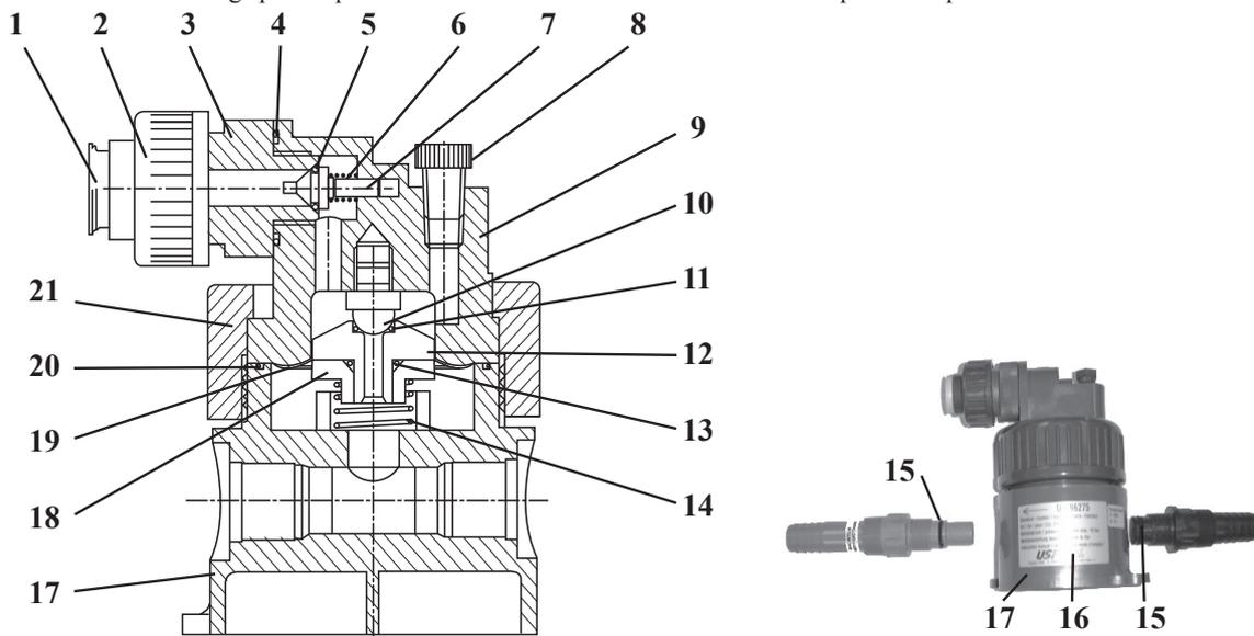
**FIG.8 U.96275 - 19mm INJECTOR**
