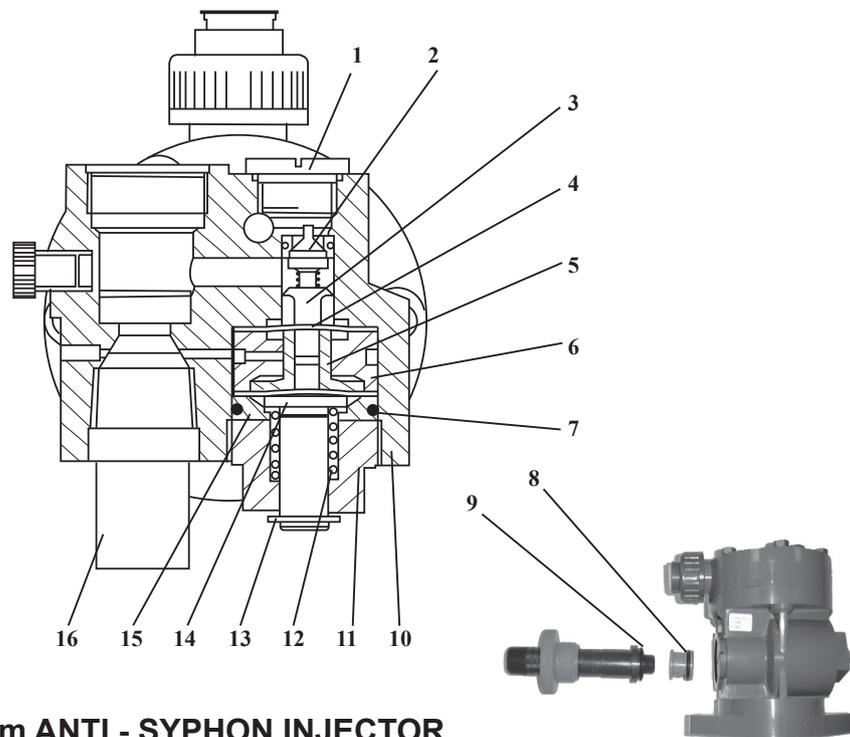
**FIG.7 U.96274 - 25mm ANTI - SYPHON INJECTOR**
