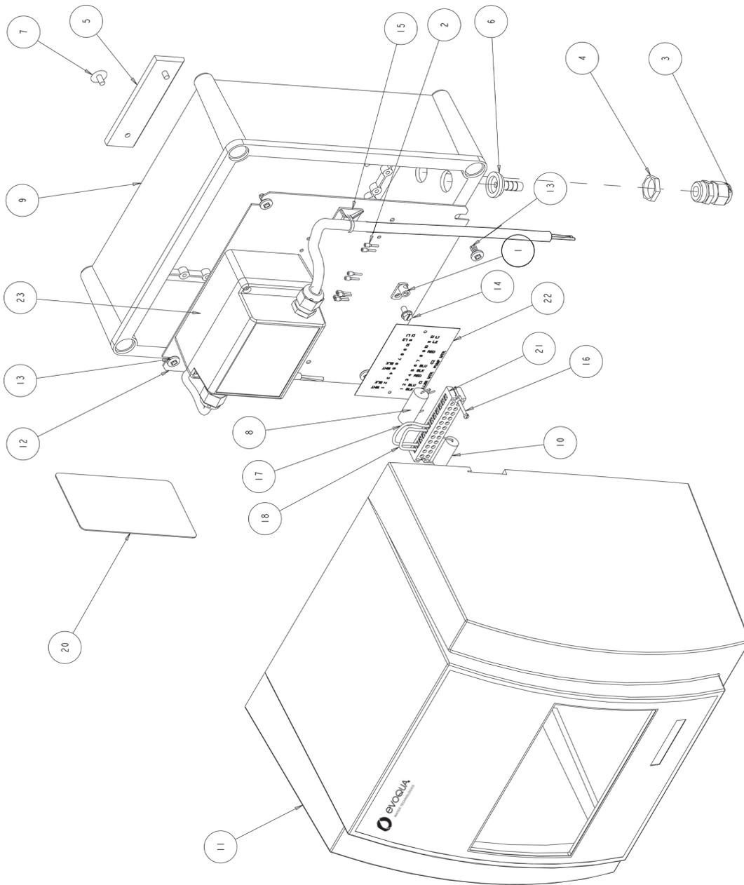
**MICRO/2000® AND DEOX/2000® CE WETSIDE ENCLOSURE ASSEMBLY - PARTS —**
